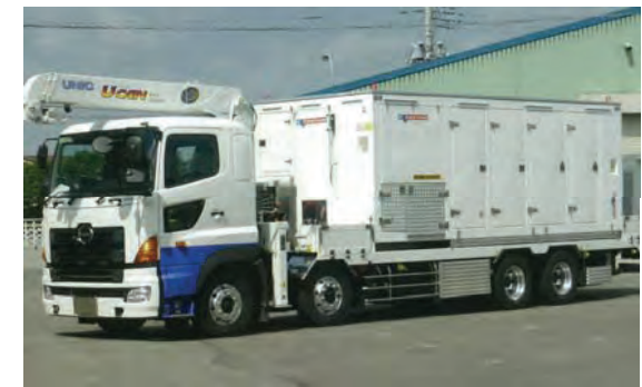
【可搬型代替注水大型ポンプ車】
