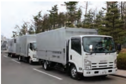
【可搬型代替低圧電源車】
