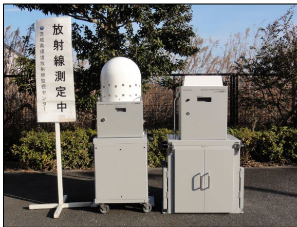
可搬型モニタリングポスト【●台】
