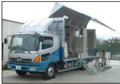
移動式体表面測定車(2台)
