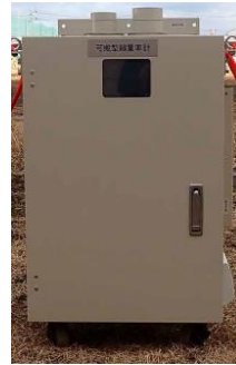
可搬型モニタリングポスト【18台】
