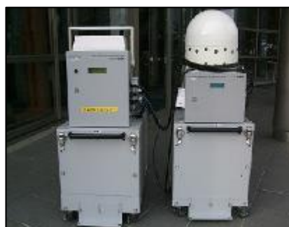
可搬型 モニタリングポスト【9台】
