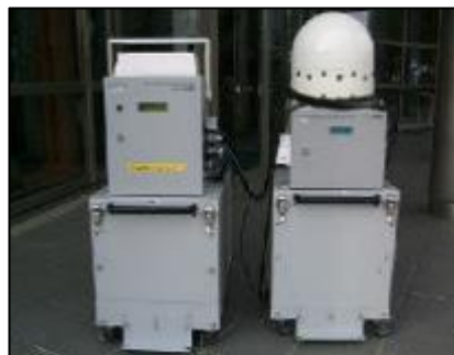
可搬型モニタリングポスト【9台】
