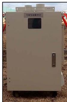
可搬型モニタリングポスト【18台】
