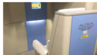
【内部被ばく検査機器の設置】
