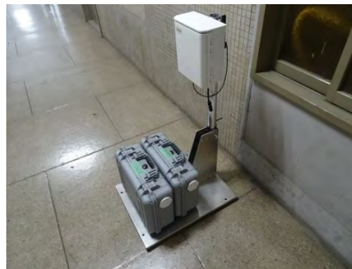
可搬型モニタリングポスト 【12台】
