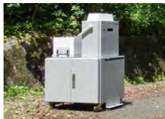
可搬型モニタリングポスト【10台】 (衛星系回線による通信機能付)
