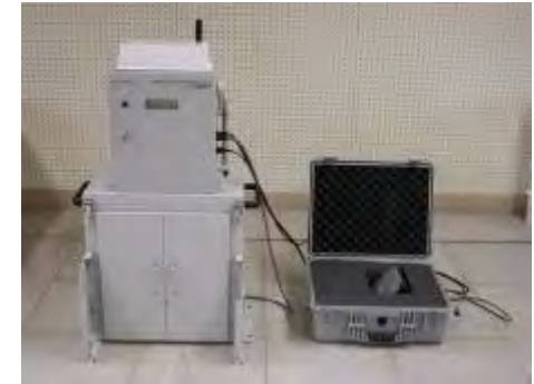
可搬型モニタリングポスト【1台】
