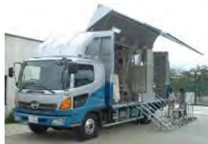
移動式体表面測定車(2台)
