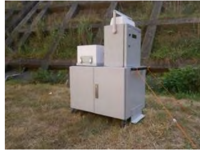
可搬型モニタリングポスト (衛星回線による通信機能付)
