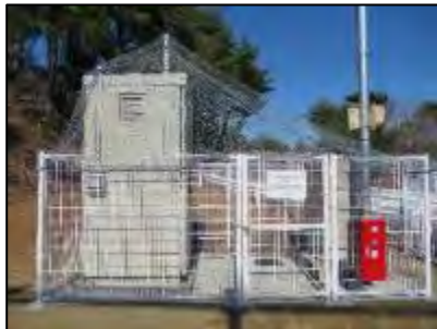
大気モニタ、オートサンプルチェンジャー 付きヨウ素サンプラ
