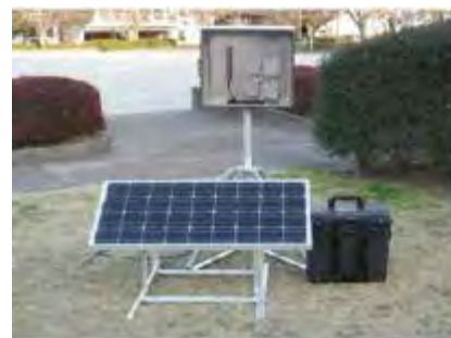
GPS追従型線量率測定装置【30台】
