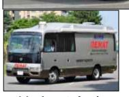
検査測定車 ミニラボ付き、線量評価測定
