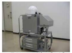
可搬型モニタリング オペスト 【19台】 (衛星電話による通信機能付)
