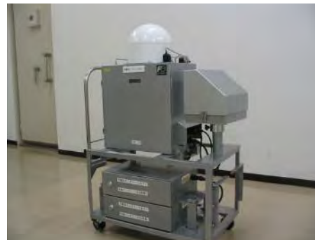
可搬型モニタリングポスト【19台】 (衛星電話による通信機能付)
