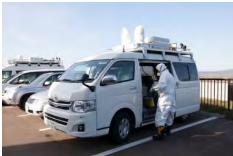
モニタリングカーによる走行サーベイ
