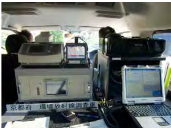
モニタリングカーの内部
