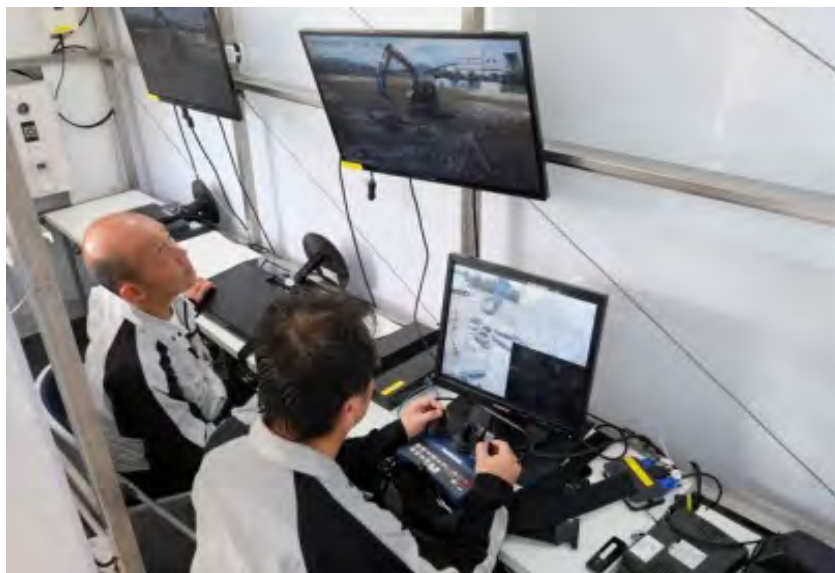
無線重機の操作
