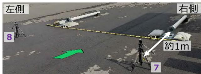
(2) ⑬⑭赤外線ケーブルと⑤赤外線センサを、**同じケーブル番号同士(7～10)**で**接続**(接続端子の1個の爪を合わせ真直ぐ差し込む)し、**接続端子を1/8回転してロック**する。
