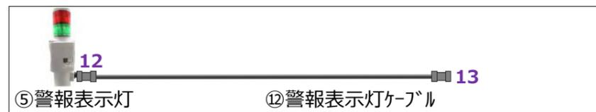
(1) ④警報表示灯を設置し、⑫警報表示灯ケーブルの**同じケーブル番号同士(12)**を**接続**(5個の爪を合わせ真直ぐ差し込む)する。
