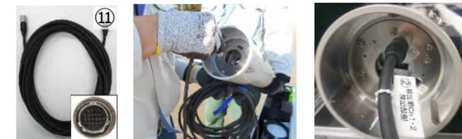
(2) ②検出器と③台座の▲印が合うように接続し、両側のパチパチ2個を施錠(ロック解除ボタンを押しながら解錠)する。⑪**検出器ケーブルは台座の切欠きに通す**。
