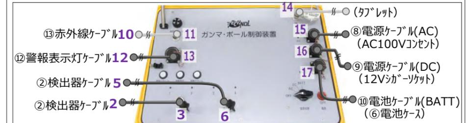
**Point** 雨天時は①制御装置に大ポリ袋を被せ、防滴性を補強する。
