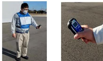
(3) 測定値が、ゲートモニタが運用可能な空間線量率の上限を下回っているか確認する。上限を超える場合は、無線・トランシーブ等を用いて、車両指定箇所検査班にゲートモニタのバックグラウンド計数率の確認を指示する。
