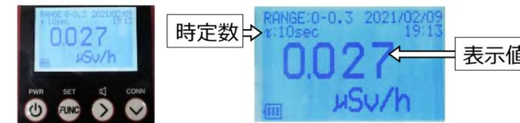
(2) デジタル画面の測定値が、「 $\mu$ Sv/h」表示であることを確認する。測定値が「 $\mu$ Sv/h」表示以外の場合はボタを数回押しして合わせる。
