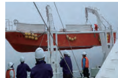
上陸に向けた準備（国後島） 上陸用小型船舶の2点吊り
