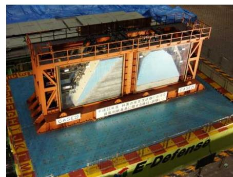
JNESでは、安全上重要な設備等の耐震強度を把握するための各種試験を行う。(写真は、(独)防災科学技術研究所の振動台(兵庫県三木市)を用いた建屋の背後斜面の安定性を評価するための実験の様子)
