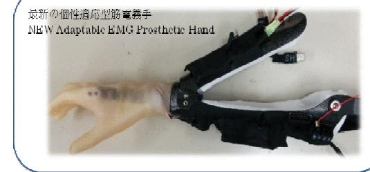
1. 最新の個性適応型筋電義手
