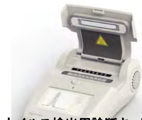
ジカウイルス検出用診断キットの一部 (等温増幅蛍光検出装置)
