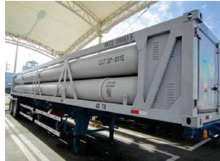
高圧ガス用 ISO規格 40FTタンクコンテナ (コンテナ自重: 23トン型)
