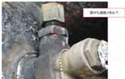
溶栓弁付き元弁の状況 溶栓は120で溶けるので、作動し水素が放出されたと推測。
