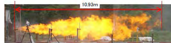
水素（60MPa、口径4mm）での火炎状況 （出典：三菱重工業(株)の実験）
