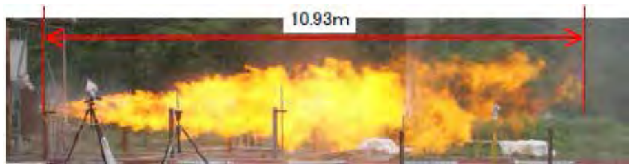
水素（60MPa、口径4.0mm）での火災状況 （出典：三菱重工業(株)の実験） NEDO委託研究として実施
