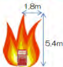
吐出量50L/minでガソリン火災が継続した場合の火炎状況の例（消防庁試算）
