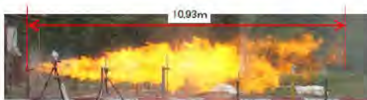
水素（60MPa、口径4.0mm）での火炎状況 （出典：三菱重工業（株）の実験※） ※NEDO委託研究として実施
