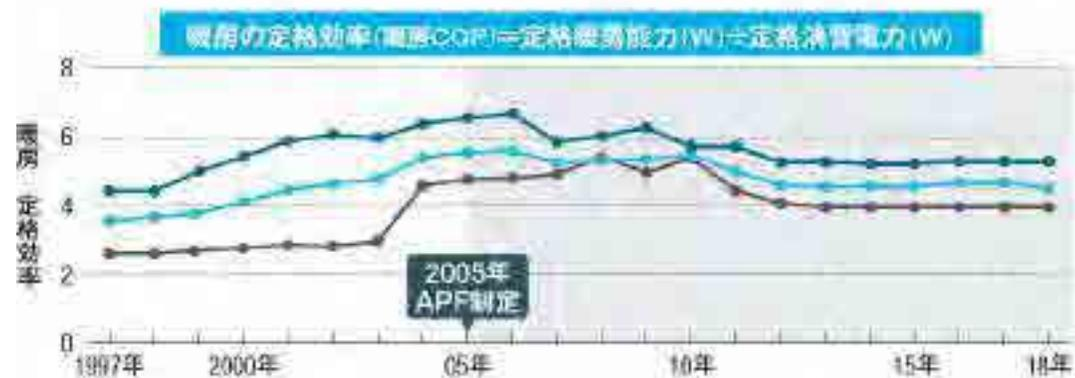
冷房と暖房の定格効率と通年エネルギー消費効率 (APF) の推移 (冷房能力2.8kW機種)。エアコンの効率評価が暖房 COP (定格効率) から APFに移行するのに伴い、定格効率は低下傾向にある。APFも、10年以降は平均値が全く伸びなくなっている
