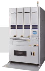
レセコンと連動し 自動錠剤分包機 による分包
