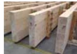
正角材を積層した重ね梁・束ね柱
