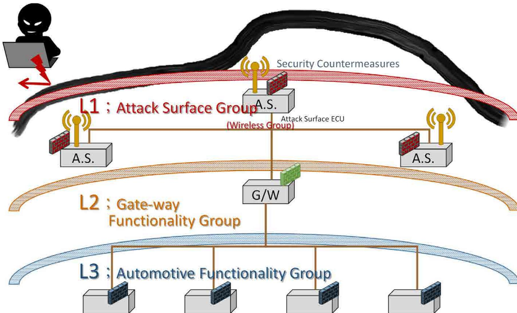
制御ユニットを機能群別に階層配置し、複数壁を設ける多層防御アーキテクチャの適用が拡大
