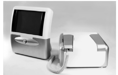
開発したソフトウェア無線機の外観図 左:表示部(カメラによる動画撮影機能付き、 右:無線信号処理部)
