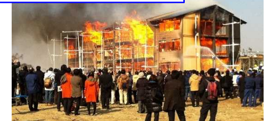
木造3階建て学校の実大火災実験
