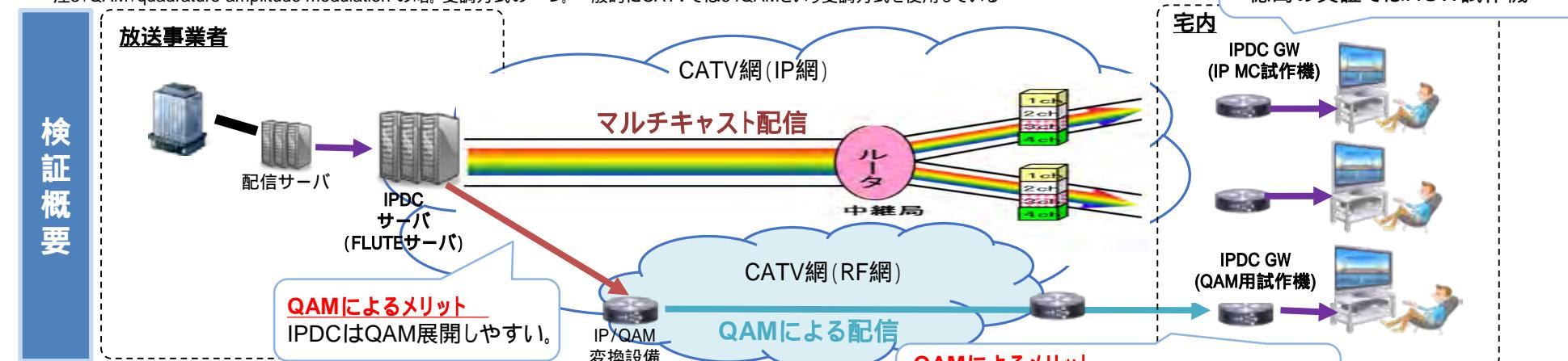
QAM方式とは、RFの波をQAMの変調方式に変換してデータを送る方式。
