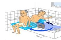
・ロボット技術を用いて浴槽に出入りする際の一連の動作を支援する機器
