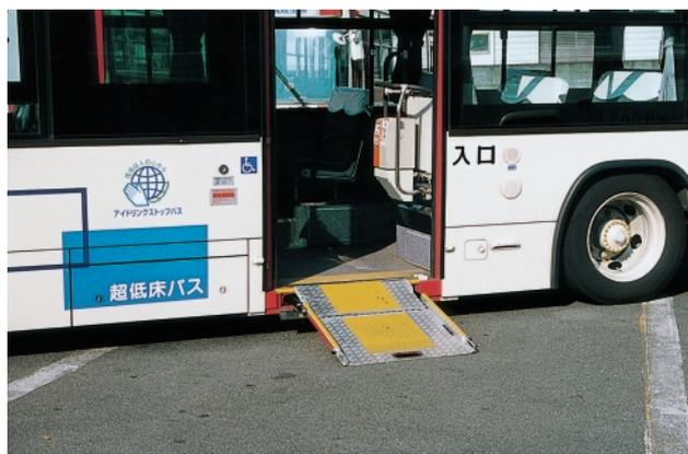
路線バスに導入されている超低床ノンステップバス(静岡県)
