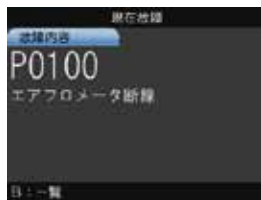
ダイアグコード(故障コード) センサの断線など、故障箇所や状態を表示するコード
