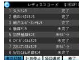
J-OB (レディネスコード) 排気ガス発散防止装置等の作動状態の診断結果を表示する機能
