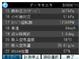
データモニタ エンジン回転数など、各種装置の作動状況を読み取る機能
