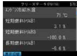
フリーズフレームデータ 異常が発生して故障コードが記録された時点の各種装置の作動状況を表示する機能
