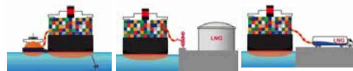
船舶へのガス燃料の移送方法
