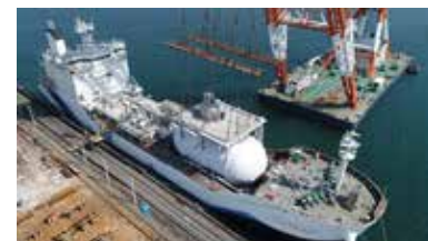
建造中の世界初の液化水素運搬船 出展：川崎重工業
