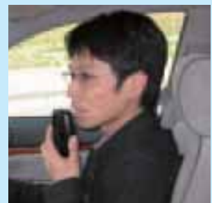
エンジン始動前にアルコール・インターロック装置に呼気を吹き込んでいる様子 資料提供:(財)日本自動車研究所
