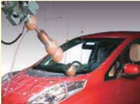
自動車のボンネット部の歩行者保護性能評価試験の様子
