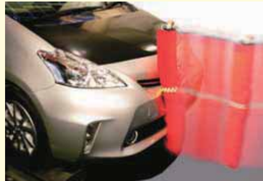
自動車のバンパー部の歩行者保護性能評価試験の様子
