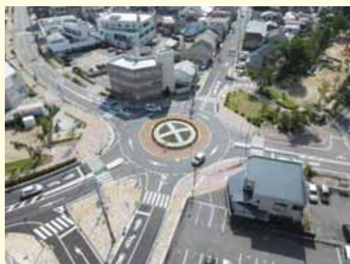
ラウンドアバウト構造を持つ平面交差点部 （長野県飯田市の東和町交差点）
