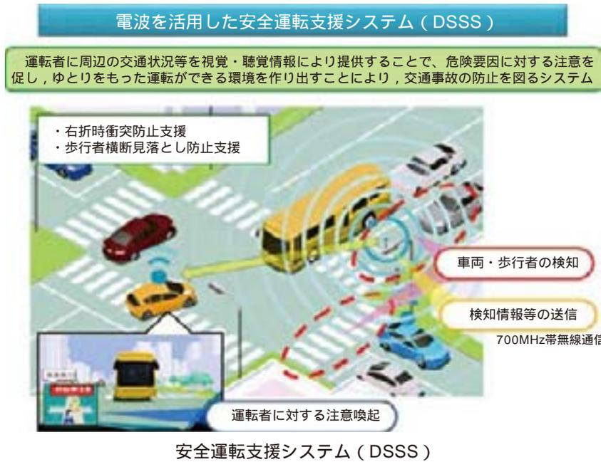
ETC2.0車載器により、ETCに加え、渋滞回避支援、安全運転支援といった情報提供サービスを提供するETC2.0サービスの普及が進められているところであり、交通事故の抑止への効果が期待される。
