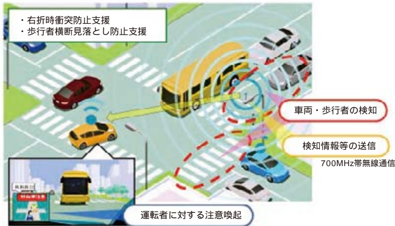
安全運転支援システム (DSSS)
