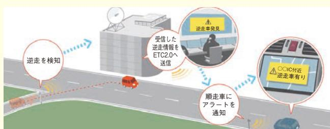
逆走車両の検知、管制センターを介した順走車両への警告（2018年度頃のイメージ）
