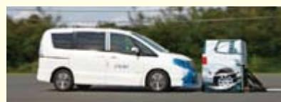
試験は、ターゲットが止まった状態での試験と、20km/hで走行している場合の2種類があります。警報またはブレーキの作動により衝突を回避した場合、あるいは衝突した場合でも、衝突前にどの程度速度が低下していたかに応じて得点が与えられます。
