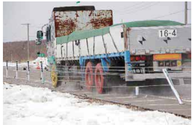
写真 ワイヤロープ式防護柵の性能確認試験
