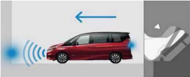
ペダル踏み間違い急発進抑制装置（イメージ）
