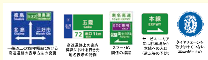
新設された道路標識
