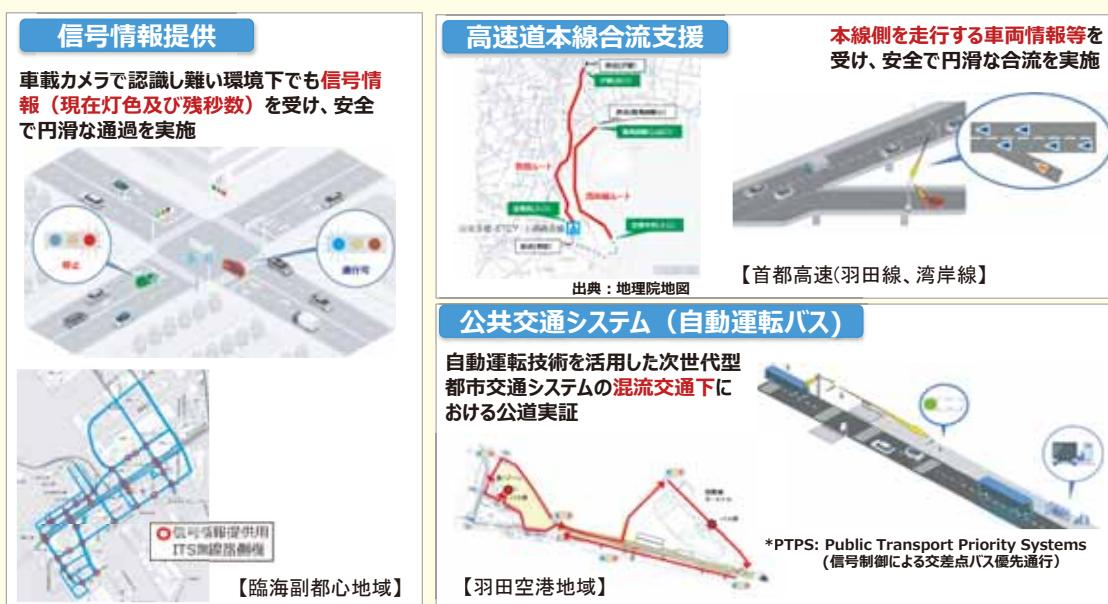
さらに羽田空港と臨海副都心等を結ぶ首都高速道路において、道路の車道レベルの情報だけでなく、道路の車線レベルでの道路交通情報も有用であり、自動車・ナビメーカー等の有する民間のプローブ情報及び官の情報（落下物情報、事象規制情報等）を収集し、道路の車線レベルでの道路交通情報を作成するために必要な研究開発を実施している。
