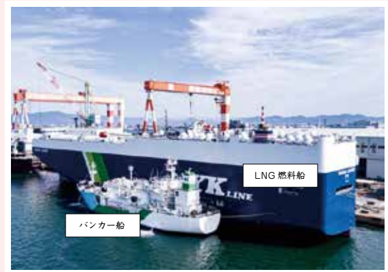
図2. バンカー船によるLNG燃料供給の様子
